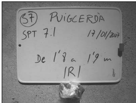
Foto 37: Material extret de l'assaig SPT-7.1 d'1,80 a 1,90 m de profunditat.
