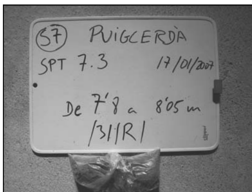
Foto 39: Material extret de l'assaig SPT-7.3 de 7,80 a 8,05 m de profunditat.
