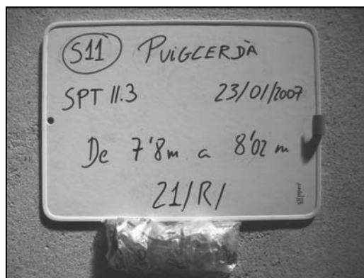
Foto 51: Material extret de l'assaig de SPT-11.3 de 7,80 a 8,02 m de profunditat.
