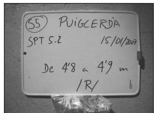
Foto 32: Material extret de l'assaig SPT-5.2 de 4,80 a 4,90 m de profunditat.
