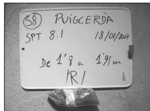
Foto 40: Material extret de l'assaig SPT-8.1 d'1,80 a 1,91 m de profunditat.
