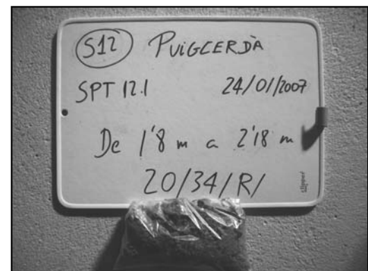
Foto 52: Material extret de l'assaig SPT-12.1 d'1,80 a 2,18 m de profunditat.
