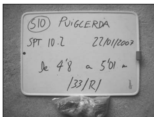
Foto 47: Material extret de l'assaig de SPT-10.2 de 4,80 a 5,01 m de profunditat.
