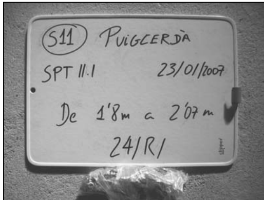
Foto 49: Material extret de l'assaig SPT-11.1 d'1,80 a 2,07 m de profunditat.
