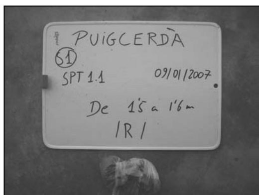
Foto 15: Material extret de l'assaig SPT-1.1 d'1,50 a 1,60 m de profunditat.
