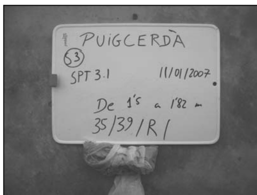
Foto 23: Material extret de l'assaig SPT-3.1 d'1,50 a 1,82 m de profunditat.
